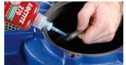
Demontáž pomocí běžného ručního nářadí je velmi obtížná; povolení spoje může vyžadovat místní ohřev na teplotu vyšší než 200 °C. Vhodné pro trvalé sestavy na těžkých strojích, čepy, upevnění motorů a čerpadel, pro velikost závitů do M80.
